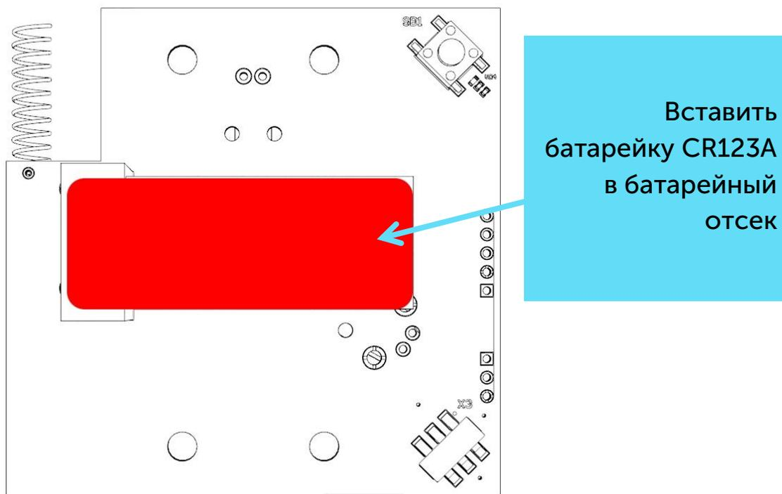
После установки батарейки датчик сразу начинает работать в режиме «Активный» и выполнять свои функции по обнаружению задымления вне зависимости от наличия регистрации в сети LoRaWAN. Датчик поддерживает два способа активации в сети LoRaWAN – ABP и OTAA. Выбрать один из способов можно с помощью программы «Vega LoRaWAN Configurator» (см. раздел 4).
